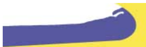
図13 フレア護岸で反射される波 Fig.13 Reflected wave at flaring shaped seawall
