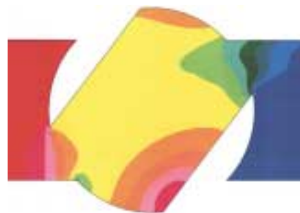
図7 ボール弁内部の圧力分布 Fig. 7 Pressure contour in ball valve
