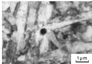
図1 被覆アーク溶接金属の電子顕微鏡ミクロ組織
