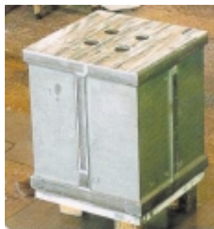
a) スーパーメガフレーム用鋳鋼ブロック a) Cast block for super mega-frame
