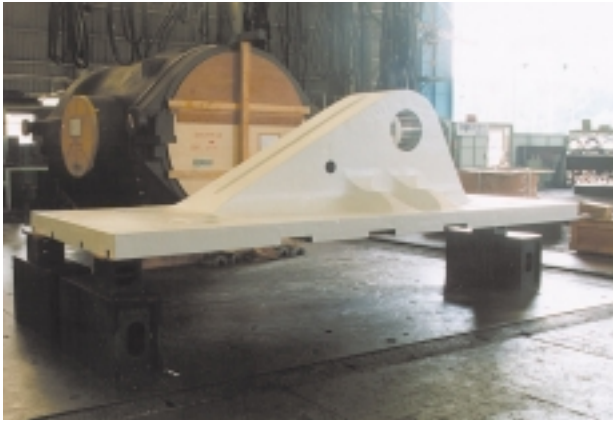
写真4 橋梁用メインサポート鋳鋼品 Photo 4 Main support casting for bridge
