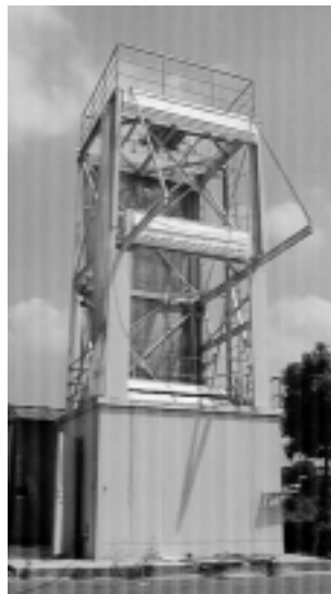
写真1 雨音試験装置 Photo 1 Test equipment for rainy noise
