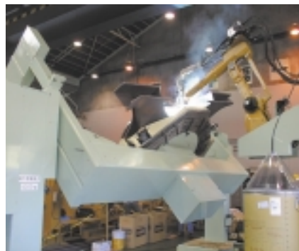
写真1 タンデムアーク溶接ロボットシステムの適用例
