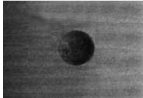
図7 基板上に観察されたスプラッシュの一例
