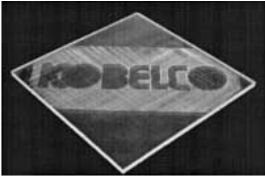
図10 SiO x 保護ポリカーボネートの耐傷性 Fig.10 Scratch test of SiO x coating polycarbonate
