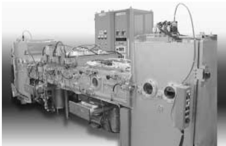
図5 インライン装置外観 Fig. 5 In-line sputtering system
