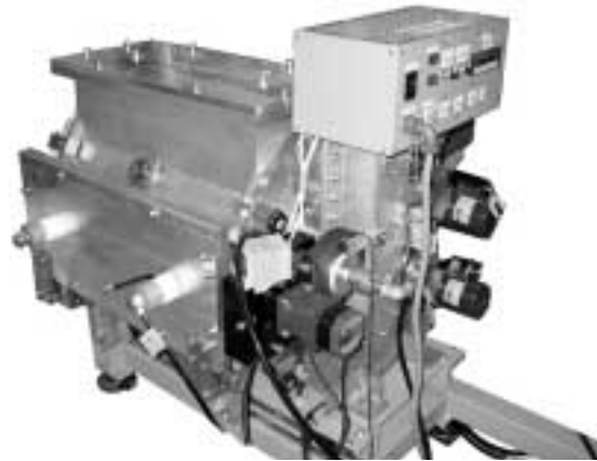
図6 ロールコータ装置外観 Fig. 6 Roll coater sputtering system
