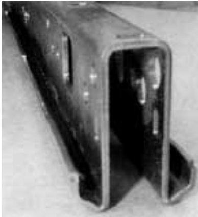
写真 2 シート部材の成形品例 Photo 2 Application to automotive seat parts
