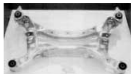
写真2 アルミニウム合金で作られたリア・サブフレーム 4) Photo 2 Rr. sub-frame made by aluminum alloys 4)
