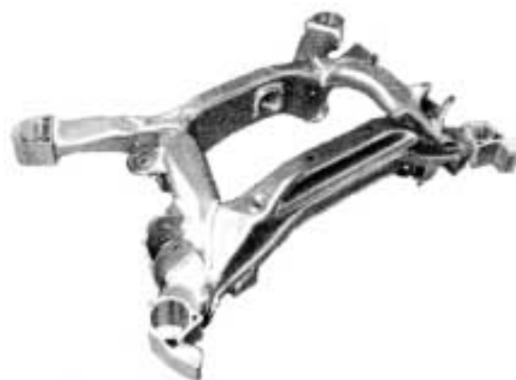
図8 アルミ製サブフレームの例 10)
