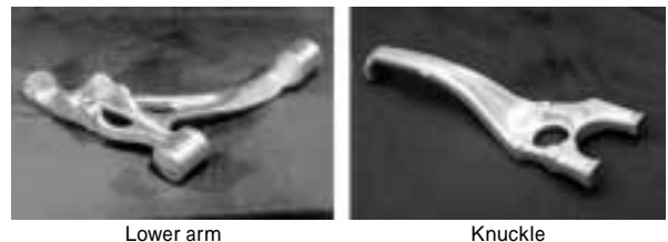
写真1 アルミ鍛造足回り部材例 Photo 1 Aluminum forgings for suspension parts
