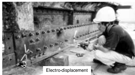
写真1 熱プレストレス導入実験状況 Photo 1 Scene of experiment of thermal pre-stressing
