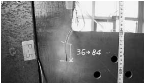
写真3 あて板補強 ( A_p ) の試験後 Photo 3 Fatigue crack of A_p specimen
