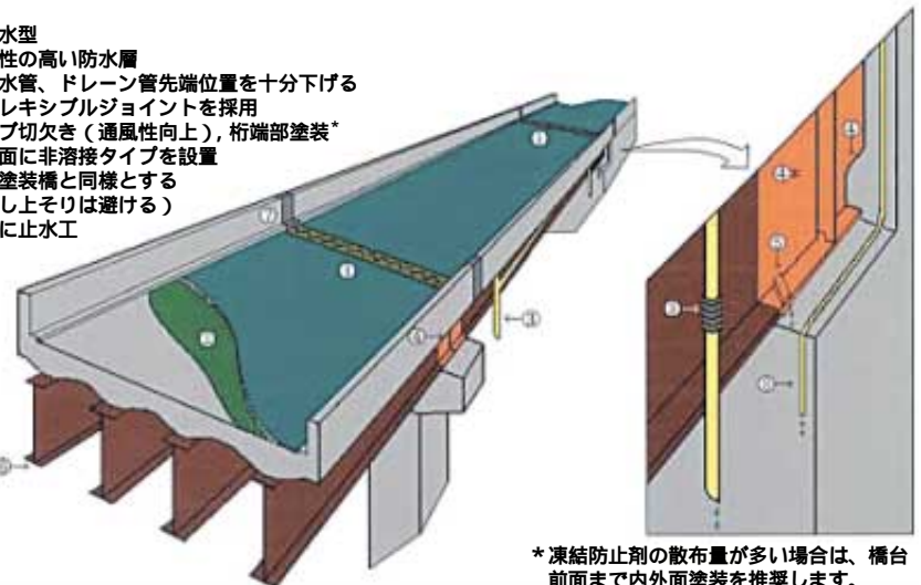
図6 耐候性鋼を使用した橋梁における設計施工上の重要管理ポイント 13)
