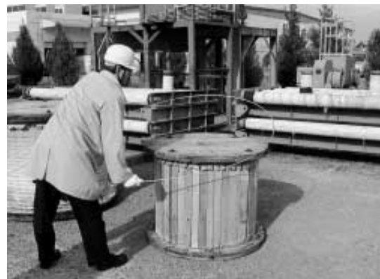
写真5 太径ワイヤ取扱い試験 Photo 5 Treatment test of 7mm wire
