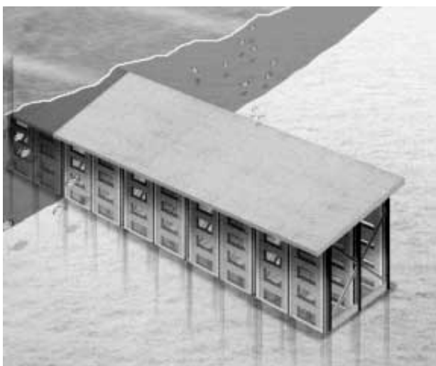
図 1 斜板とスリット板を複合した消波構造 Fig. 1 Wave energy dissipating structures with multi slit walls and a slant-ceiling panel
