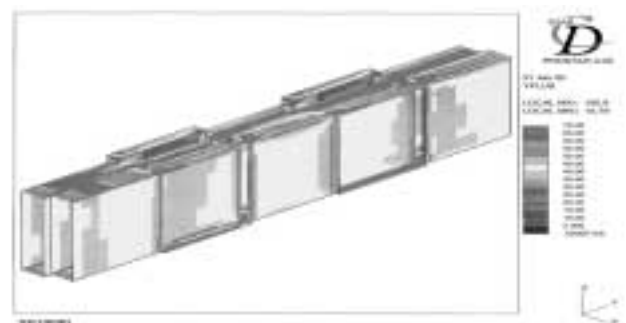
図4 フィン部の伝熱解析の例 Fig. 4 Example of heat transfer analysis for fin
