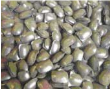
写真5 成型した改質炭 Photo 5 Briquetted UBC
