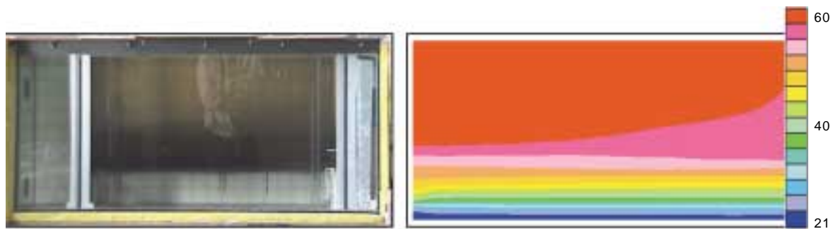
図3 水蓄熱槽の模型実験とシミュレーション結果
