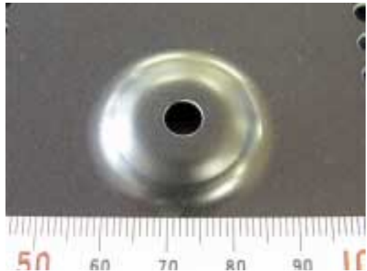
写真2 張出し加工部
