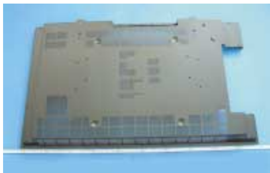
写真1 成形例(プラズマディスプレイリアカバー)
