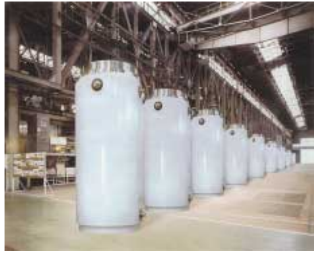
写真 5 TN24 型輸送・貯蔵容器 Photo 5 TN24 type transport/storage cask
