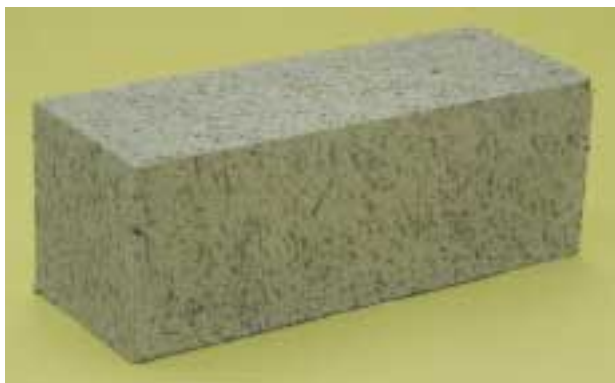
写真 1 耐熱性コンクリートの断面サンプル Photo 1 Cut sample of heat resistant concrete
