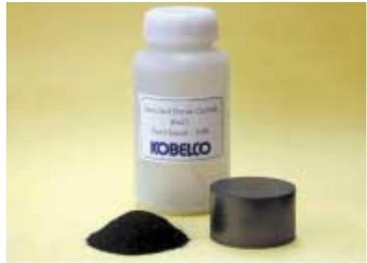
写真4 濃縮ボロン添加炭化ほう素 (B 4 C) Photo 4 Enriched boron carbide (B 4 C)
