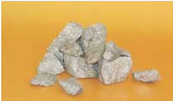
写真2 濃縮ボロン添加フェロボロン (FeB) Photo 2 Enriched borated ferro-boron (FeB)
