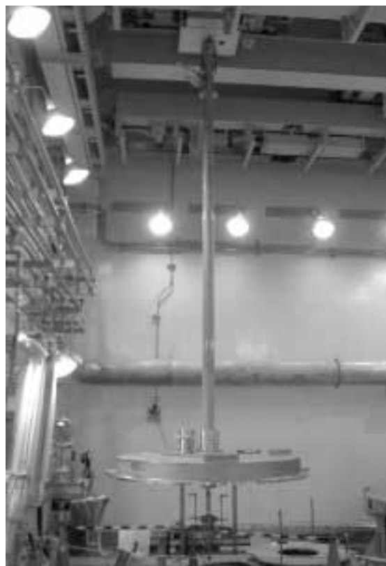
写真2 輸送容器内面除染装置 Photo 2 Washing bar
