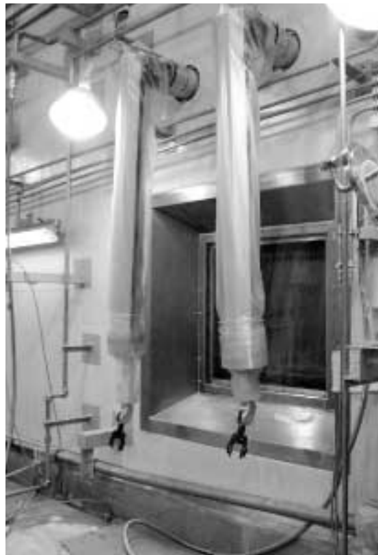
写真1 マススレーブマニプレータ（マスタアーム） Photo 1 Master slave manipulator (master arm)
