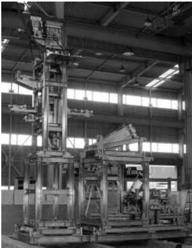
写真1 BP 棒減容装置 Photo 1 BP volume reduction equipment
