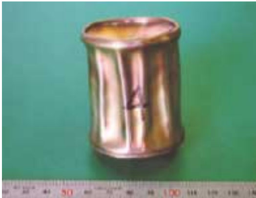
図4 HIP 処理後の HIP カプセルの外観写真 12) Fig. 4 Overview of HIP capsule after HIP treatment 12)
