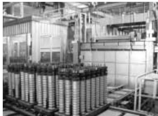
写真2 積付け焼鈍されたブランク Photo 2 Stacked disks for stress-relief annealing to be flated
