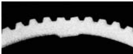
写真1 コンデクロスの管軸直角断面
