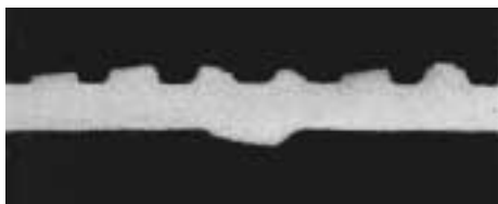
写真2 コンデクロスの管軸平行断面
