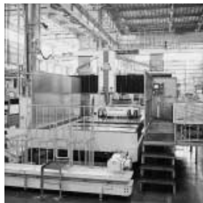
写真 2 大型 5 面加工機 (加工能力 6 250 × 3 820 × 2 000mm)
