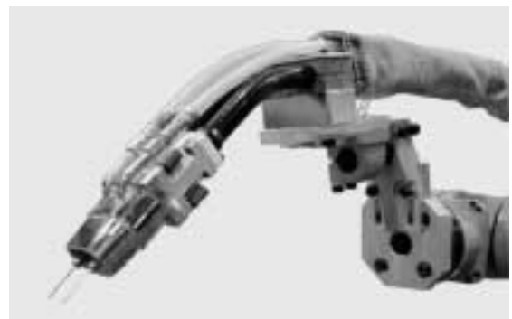
写真1 タンデムトーチ Photo 1 Tandem welding torch
