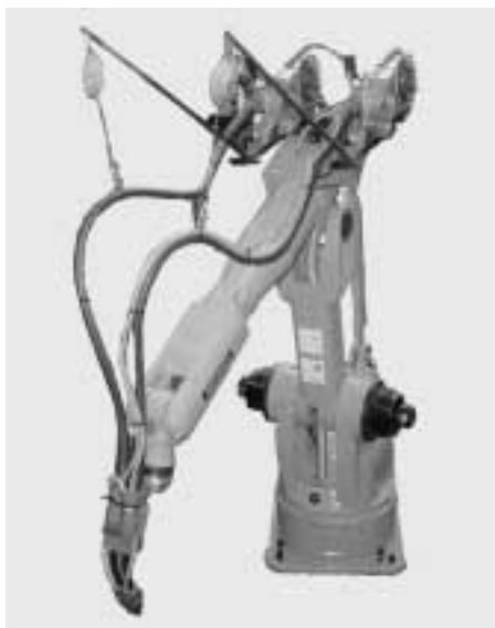
写真3 タンデム溶接ロボット Photo 3 Tandem welding robot
