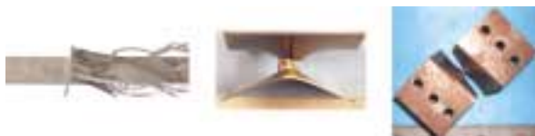
図3 引張試験後の変形
