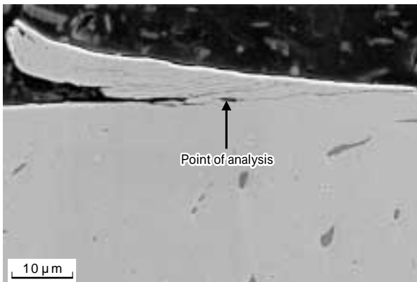
写真6 切屑スケールと切屑界面に観察される展伸された MnS 介在物の例 Photo 6 Example of elongated MnS inclusion between the scale and chip
