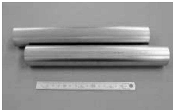
写真3 Ti-1.5%Al の溶接管の外観写真 Photo 3 Ti-1.5%Al welded tubes ( 38.1 x 1mm )
