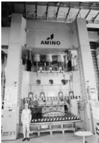
写真1 成形試験用 1000ton 大型油圧プレス機 Photo 1 1000 ton hydraulic press for forming test
