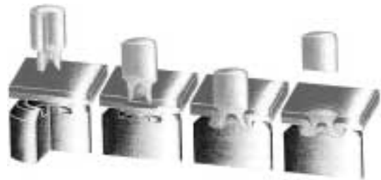
図4 セルフピアシングリベット (SPR) の模式図 Fig. 4 Schematic illustration of self piercing rivet (SPR)
