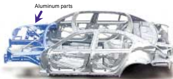
図1 BMW 5シリーズのアルミニウム合金製フロント構造 4) Fig. 1 Aluminum front end in BMW 5 series 4)
