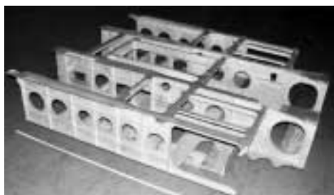
Material : D357.0-T6 alloy Size : 1850mm×1550mm×342mm, 2.0tmm
