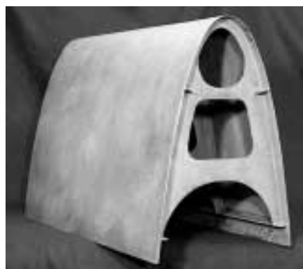
Material : D357.0-T6 alloy Size : 600mm×400mm×600mm, 2.0tmm
