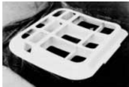
Material : D357.0-T6 alloy Size : 620mm×600mm×80mm, 1.5tmm
