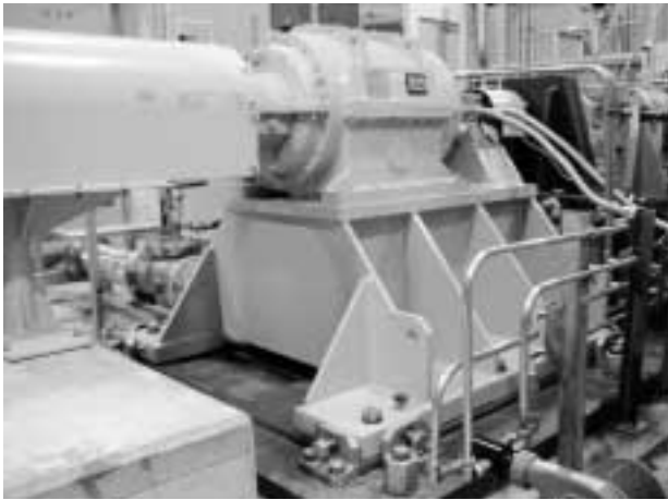
写真3 62 000rpm 増速機 Photo 3 62 000rpm epicyclic gear
