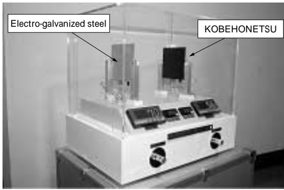
写真1 コーベホーネツの放熱板としての性能確認試験 Photo 1 Method to evaluate performance of KOBEHONETSU as a radiator plate
