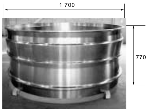
写真1 ファンケースフロント納品形状 Photo 1 Shipment shape of fan case front
