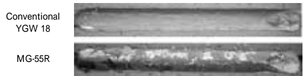
写真4 スラッグ剥離性の比較
