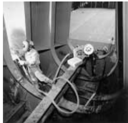
写真 1 全姿勢用スラグ系 FCW の船舶への適用例 (DW-100) Photo 1 Application of slag type FCW to vessels (DW-100)
