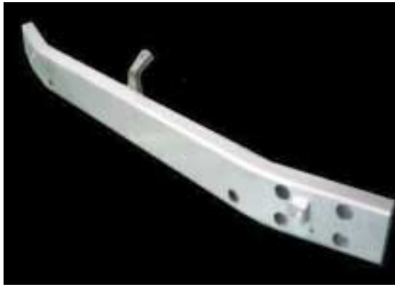
図6 アルミ押出材を用いたバンパビーム例 Fig. 6 Example of aluminum bumper beam
