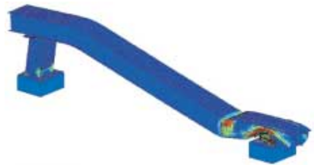
図8 オフセットバリア衝突FEM解析結果例 Fig. 8 Deformation behavior of offset barrier impact analysis
