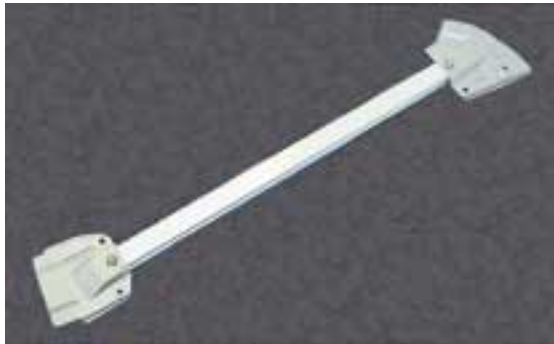
図7 アルミ押出材を用いたドアビーム例 Fig. 7 Example of aluminum door beam
