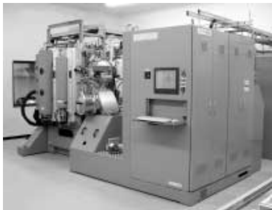
図 2 複合型 PVD 成膜装置 / AIP-S70 複合 Fig. 2 AIP/UBMS combined system / AIP-S70 Hybrid
