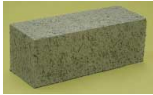
写真4 耐熱性コンクリートの切断サンプル Photo 4 Cut sample of heat resistant concrete
