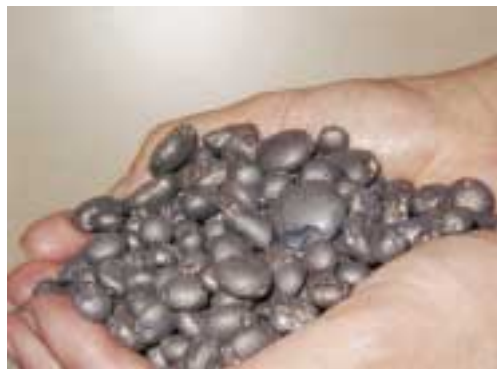
写真 5 製品粒鉄 (ナゲット) Photo 5 ITmk3 product "Iron nuggets"
