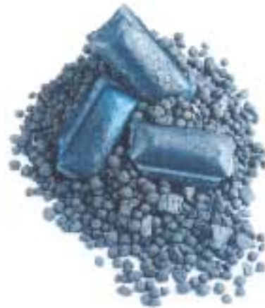
写真2 DRI と HBI Photo 2 DRI and HBI
