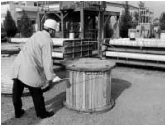
写真 3 太径ワイヤ取扱い試験 Photo 3 Treatment test of 7mm wire
