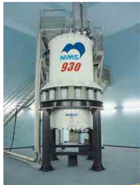
写真2 930MHz NMR 用超電導マグネットの外観 Photo 2 Outside view of 930MHz NMR superconducting magnet
