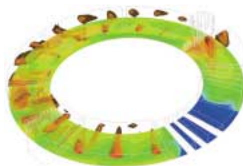
図11 ITmk3の回転炉床炉内シミュレーション結果
