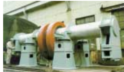
写真4 実体疲労試験装置 Photo 4 Fatigue testing machine for actual-sized crankthrow
