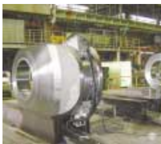
写真5 自動超音波探傷装置
