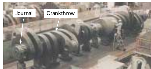
写真 1 組立型クランク軸 Photo 1 Build-up type crankshaft
