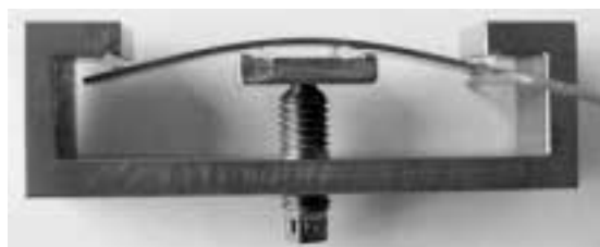
写真2 4点曲げによる遅れ破壊試験の試験片設定状況
